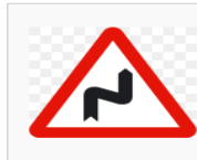
P-14a Curvas peligrosas hacia la derecha
