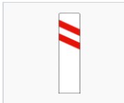
P-10b Aproximación de un paso a nivel o de un puente móvil (lado izquierdo)
