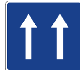
S-11a Calzada de sentido único
