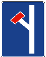
S-15c Preseñalización de calzada sin salida
